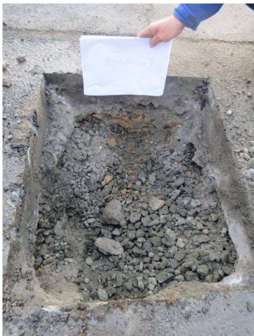
Sonda č.1 –rozhraní konstrukcí vozovky (zásyp – původní skladba)
