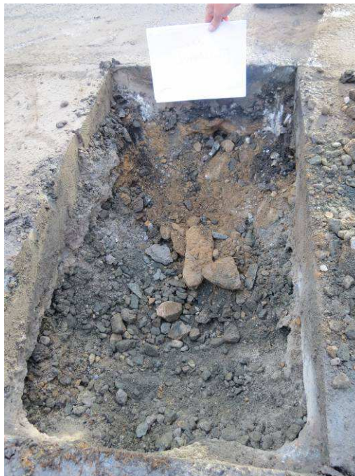
Sonda č.1 –rozhraní konstrukcí vozovky
